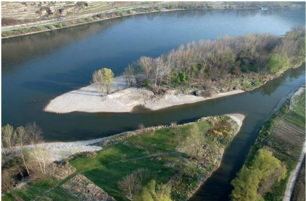
**Abb. 7:** Der untere Einströmbereich des neuen Nebenarmes in der Pritzenau (Life-Projekt Wachau) sorgt auch bei Niederwasser für eine kräftige Durchströmung. Bild: Foto Haslinger
