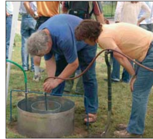
Messung der Versickerungsintensität
