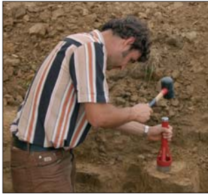
Entnahme ungestörter Bodenproben
