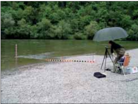
Abb. 3: Abiotische Messungen mittels Pegel und Latten, Dokumentation mit Camcorder (links); Driftnetze und Durchflussmessung (rechts)
