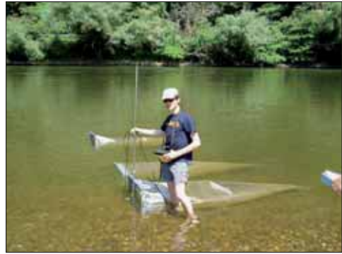
Abb. 3: Abiotische Messungen mittels Pegel und Latten, Dokumentation mit Camcorder (links); Driftnetze und Durchflussmessung (rechts)
