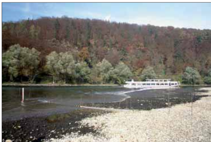
Abb. 4: Versuchsanordnung bei einer Talfahrt mit 1800 \text{ U min}^{-1} ; der massive Sog bei der Talfahrt ist anhand der dunklen Kiesflächen gut erkennbar
