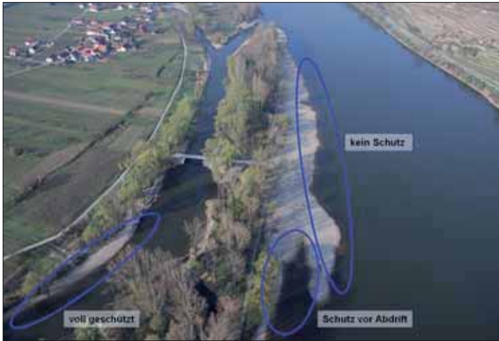
Abb. 10: Beispielhafte Lage von Jungfischhabitaten mit unterschiedlichem Schutz vor Wellenschlag. Nebenarm Pritzenau und Kiesbank im Bereich Rührsdorf
