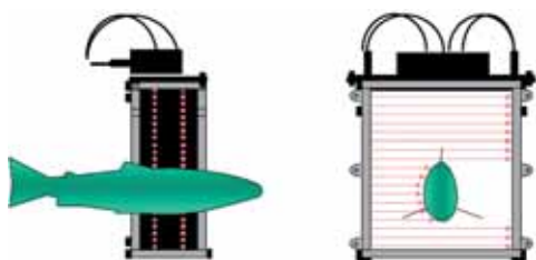
Bild 1: Funktionsskizze der Fischvermessung Skizze: BfG
