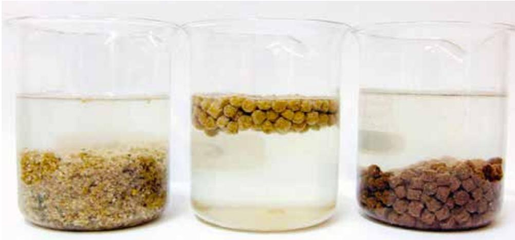
*Wasserstabilität von Fischfutter: nicht extrudiertes Futter, extrudiertes schwimmendes Futter, extrudiertes sinkendes Futter (Foto: Garant)*
