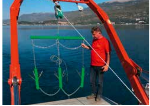
Abb. 1: Schleppanker zum Heben von Geisternetzen. Links die kleine Variante, die von Fischerbooten gezogen wurde, rechts die große Variante am mazedonischen Forschungsschiff.
