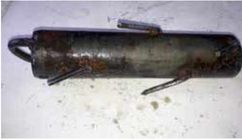
Abb. 1: Schleppanker zum Heben von Geisternetzen. Links die kleine Variante, die von Fischerbooten gezogen wurde, rechts die große Variante am mazedonischen Forschungsschiff.
