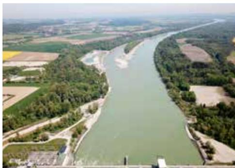
**Abb. 11:** Insel-Nebenarmsystem kurz vor Baufertigstellung mit assoziiertem Altarm (links). Nur in der unmittelbaren Stauwurzel können solche Maßnahmen umgesetzt werden, da hier Strömung und Wasserspiegelschwankungen noch am ehesten der natürlichen Situation entsprechen. Foto: W. Lauber
