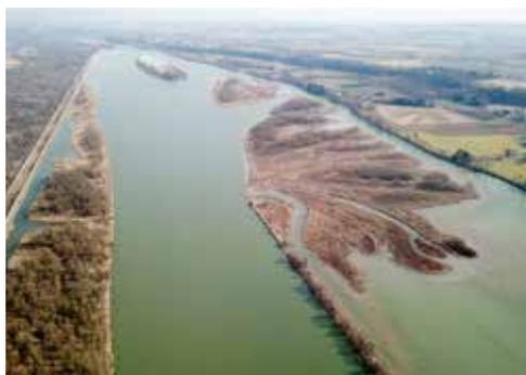
**Abb. 6:** Zentraler Stauraum des Kraftwerks Egglfing-Obernberg mit ausgedehntem Verlandungsbereich und mit Schilf und Gehölzen bewachsenen Feinsedimentinseln. Blickrichtung stromab. Foto: W. Lauber
