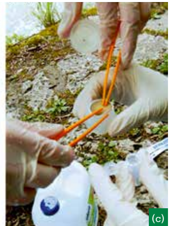
Abbildung 5: eDNA Probennahme. (a) Ein definiertes Volumen an Wasser wird aus dem Fluss entnommen (b) das Wasser wird mithilfe einer 50 ml Spritze durch einen Glasfaserfilter gedrückt (c) Der Filter, hier deutlich durch Schwebstoffe des Wassers bräunlich gefärbt, wird mithilfe von Pinzetten in ein Proberöhrchen überführt. Fotos © Sarah Sturm & I. Karner
