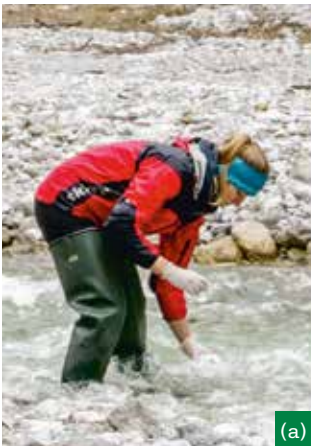
Abbildung 5: eDNA Probennahme. (a) Ein definiertes Volumen an Wasser wird aus dem Fluss entnommen (b) das Wasser wird mithilfe einer 50 ml Spritze durch einen Glasfaserfilter gedrückt (c) Der Filter, hier deutlich durch Schwebstoffe des Wassers bräunlich gefärbt, wird mithilfe von Pinzetten in ein Proberöhrchen überführt. Fotos © Sarah Sturm & I. Karner
