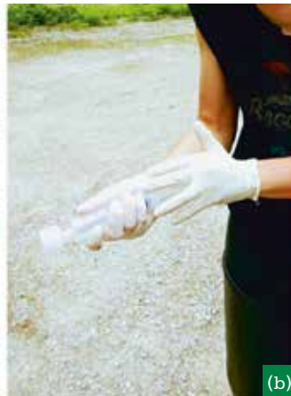
Abbildung 5: eDNA Probennahme. (a) Ein definiertes Volumen an Wasser wird aus dem Fluss entnommen (b) das Wasser wird mithilfe einer 50 ml Spritze durch einen Glasfaserfilter gedrückt (c) Der Filter, hier deutlich durch Schwebstoffe des Wassers bräunlich gefärbt, wird mithilfe von Pinzetten in ein Proberöhrchen überführt. Fotos © Sarah Sturm & I. Karner
