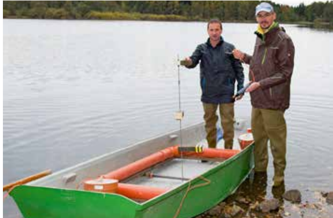
Abb. 1: Montage der Schwimmsinsel mit den Datenloggern im Sagteich © Sonja Eder
