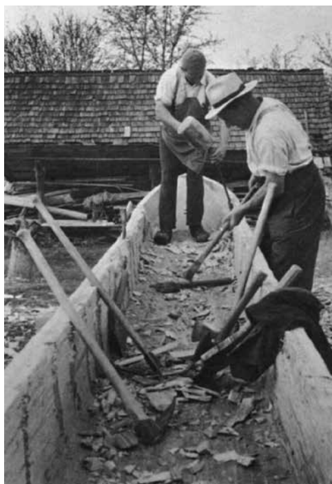
Ausarbeiten »Putzen« des »Prügls«.
