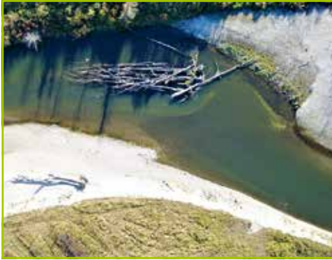
Ausschnitt aus dem strukturierten Krems-Kamp-Umleitungsgerinne. Hier befinden sich Schlüssellebensräume auf engstem Raum (rasch überströmte Kiesfurt als Kieslaichplatz, Kolk mit Totholz und Versteckmöglichkeiten, Kiesbank mit flachem Verlauf bis in den Hochwasserbereich als Jungfischlebensraum).
