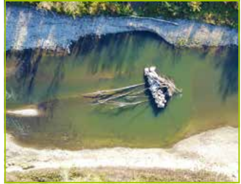
Ausschnitt aus dem strukturierten Krems-Kamp-Umleitungsgerinne. Hier befinden sich Schlüssellebensräume auf engstem Raum (rasch überströmte Kiesfurt als Kieslaichplatz, Kolk mit Totholz und Versteckmöglichkeiten, Kiesbank mit flachem Verlauf bis in den Hochwasserbereich als Jungfischlebensraum).
