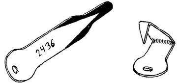
Abb. 1: Fischmarke „Fima“ aus rostfreiem Metall. Länge 25 mm, Breite 5 mm; a) aufgebogen, b) gebrauchsfertig.
