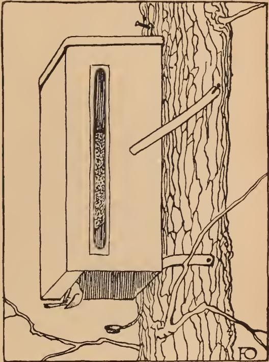
wird mit einem Henkel und verschiedenen angelöteten Bändern direkt am Baum befestigt.
