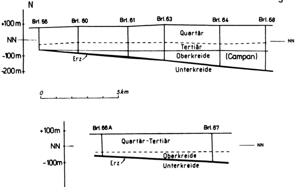
Abb. 6 N-S-Schnitte (Querprofile) durch den Nordflügel der „Dammer Oberkreide-Mulde“
