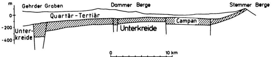
Abb. 7 Schematischer WNW-ESE-Schnitt (Längsprofil) durch den Nordflügel der „Dammer Oberkreide-Mulde“ von Gehrde bis zu den Stemmer Bergen (= Stemweder Bergen; vgl. Abb. 3, 4 und 5)
