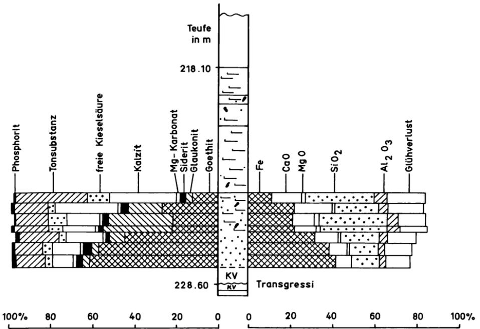
Abb. 10 Mineralbestand und Chemismus des Campan-Eisenerzes in der Bohrung Oldenburg 63 (Karte 1:25000, Bl. 3414 Holdorf, R 3442910, H 5823829; vgl. Abb. 6 und 8). Nach JANSEN (1962)
