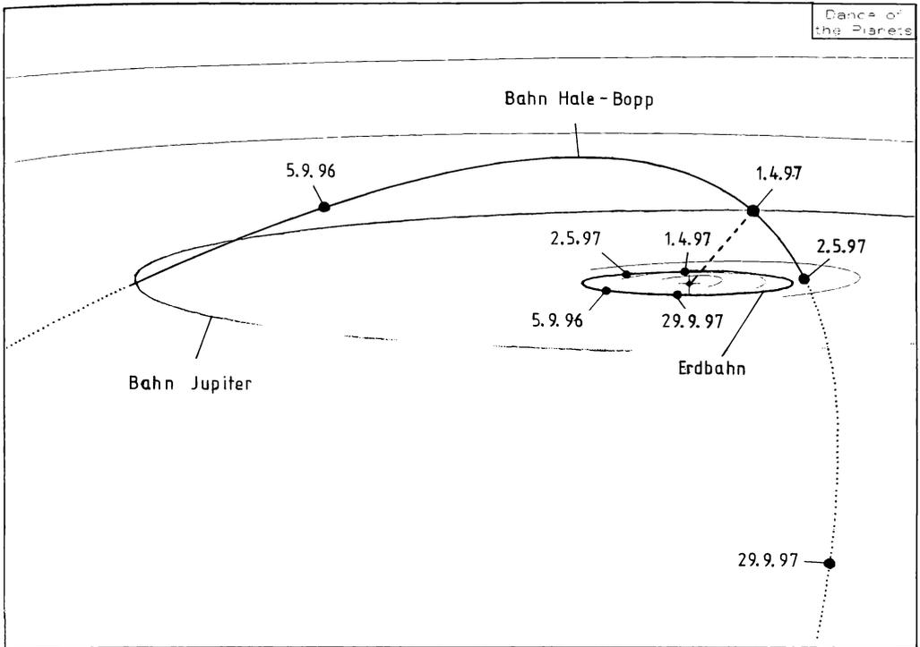
Abb. 2: Blick senkrecht auf die Kometenbahn aus einer Richtung 6 Grad über der Ekliptik. Erd- und Kometenpositionen an vier Tagen. Die dick gestrichelte Verbindung zwischen Sonne und Komet am 1.4.97 ist die Perihelentfernung von 137 Mio km
