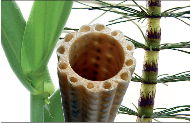
Abb. 1: Der Technische Pflanzenhalm (Mitte) ist ein strukturoptimiertes bionisches Faserverbundmaterial mit Gradientenstruktur, das hohe Steifigkeit mit sehr guter Schwingungsdämpfung und einem gutmütigen Bruchverhalten verbindet. Das Pfeifrohr ( Arundo donax , links) und verschiedene Schachtelhalmarten ( Equisetum sp., rechts) waren zwei der biologischen Vorbilder bei der Entwicklung des Technischen Pflanzenhalms, © Plant Biomechanics Group Freiburg & ITV Denkendorf (aus Speck T & Speck O 2007).
