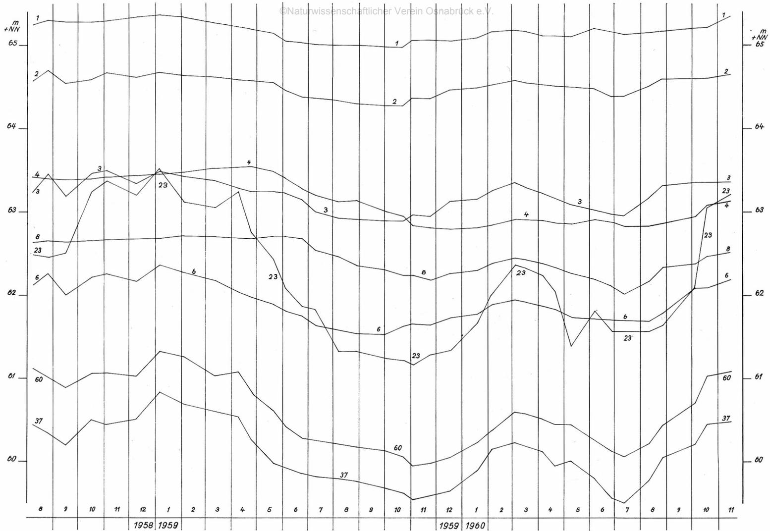
und 3, in denen die Spiegelbewegungen wesentlich abgeschwächerter verlaufen. Die Kurve des Rohres 6, das von Rohr 8 350 m talabwärts liegt, vermittelt zwischen den Kurven 8 und 37. Eine teilweise ähnlich ruhige Entwicklung vollzieht sich im Spiegelgang des Rohres 4, das außerhalb des Rubbenbruches im Quartär der ehemaligen Düte-Rinne steht (KELLER 1974).
