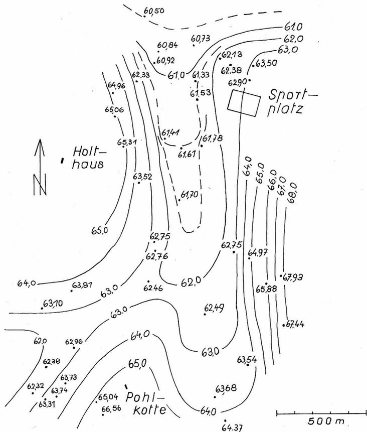
Abb. 4 Grundwasserspiegelplan des Rubbenbruchgebietes. Spiegelmaximum am 5./6. Januar 1959.
