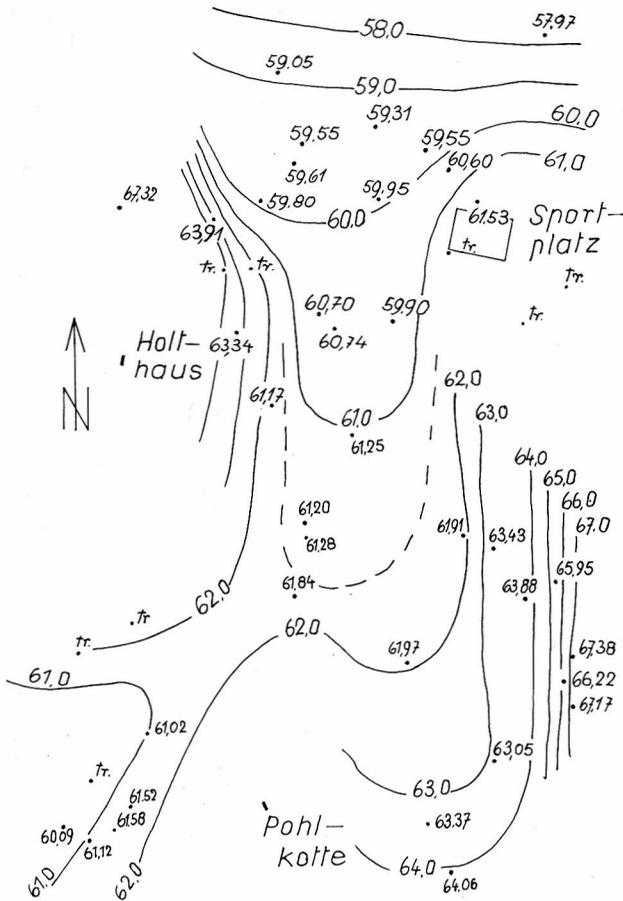
Abb. 5 Grundwasserspiegelplan des Rubbenbruchgebietes. Spiegelminimum am 2./3. November 1959.
