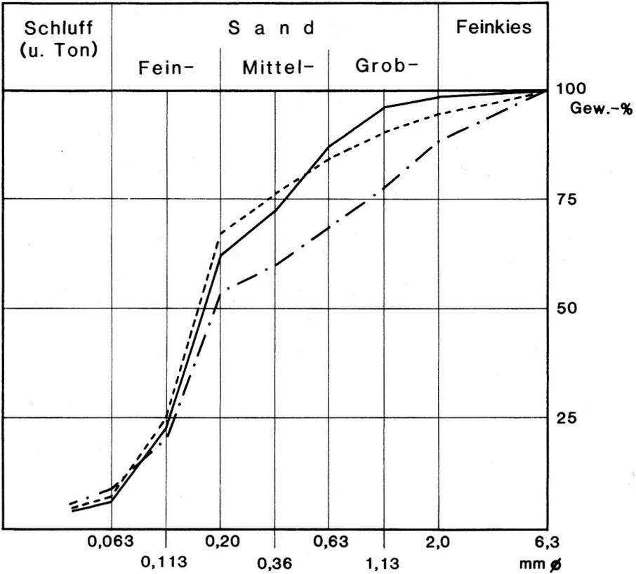
Abb. 6: Korngrößenverteilungskurven von Proben aus Schicht 6.
