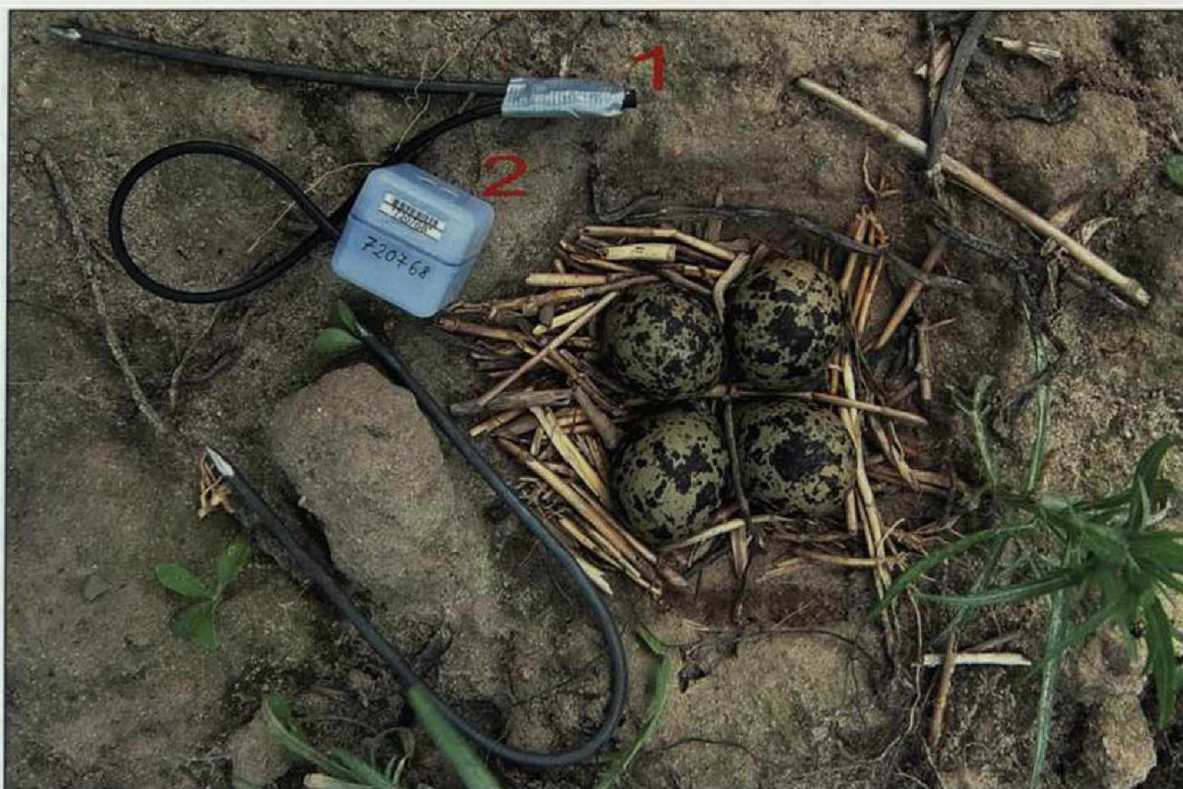
Abb. 4: Thermosensor (1) und Datenlogger (2) am Kiebitzgelege. Mit einem Metallstift im Boden befestigt, wurde der Sensor zentral zwischen die Eier postiert. Der Metallbügel dient einer zusätzlichen Befestigung des Loggers am Untergrund, denn mehrfach haben ihn Raubsäuger mit dem Nest herausgerissen und verschleppt.
