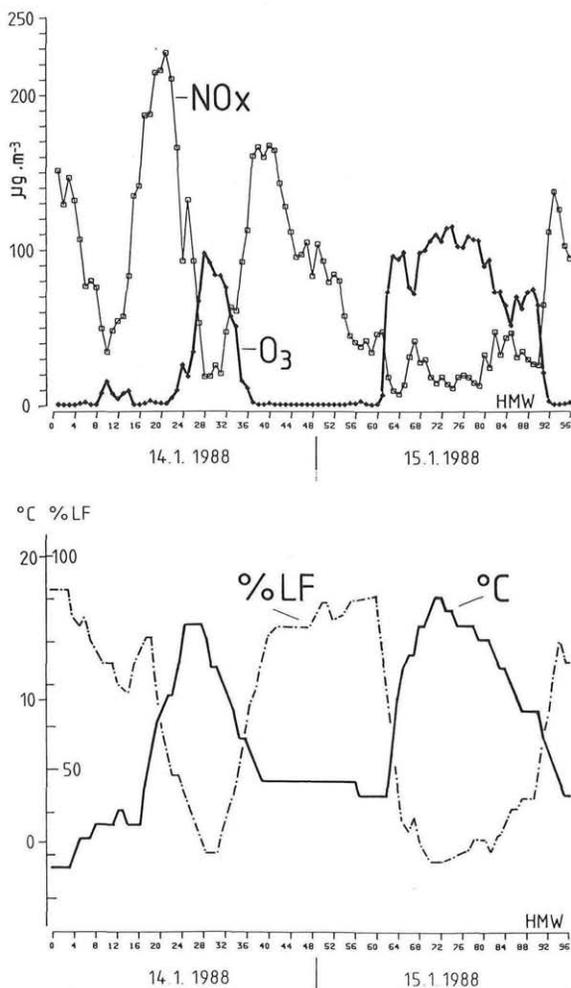
Abb. 4: Ozon- und NO<sub>x</sub>-Konzentrationen sowie Luftfeuchte und Temperaturverlauf an der Meßstation Ramsau während eines Föhnwindereignisses
