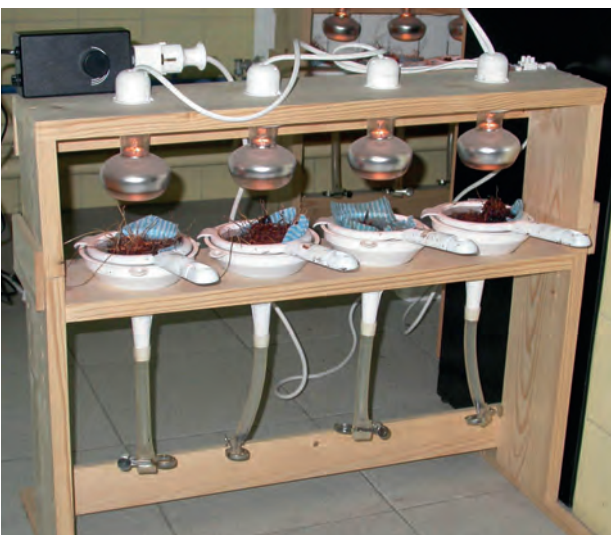
Abb. 18: Nassextraktionsanlage zur Austreibung von Enchytraeiden (Foto: R. Schmelz).
