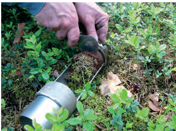
Abb. 11, 12: Probennahme mit Bodenstecher sowie Trennung von Streu und Mineralhorizont (Fotos: SMNG).
