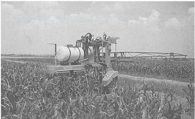
Abbildung 1: Stelzentraktor zur Maiszünslerbekämpfung
