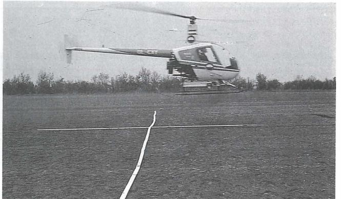
Abbildung 6: Auslegen von Papierstreifen zur Beurteilung der Abtritt und Querverteilung
