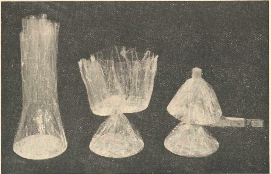
Abb. 10. Herstellung eines **Zwilling-Kegelbehälters** zur Prüfung der Kontaktgiftwirkung bei intermittierender Verweilzeit
