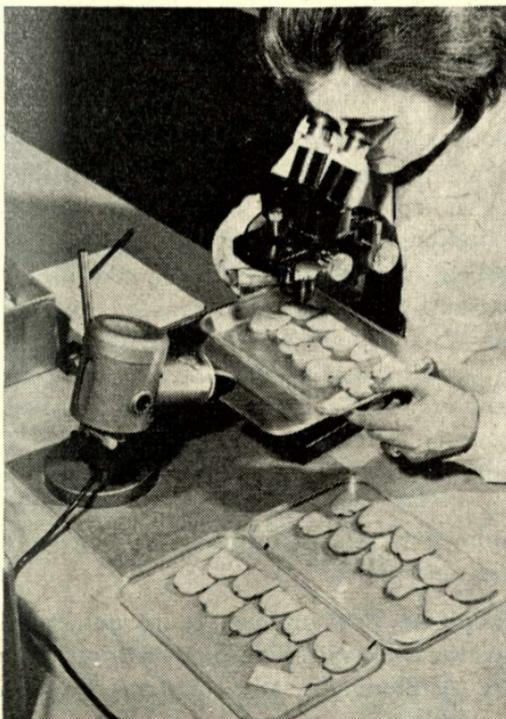
Abb. 6: Mikroskopische Untersuchung etwa 2 mm dicker gefärbter Radialschnitte im Durchlicht. Leitz-Stereomikroskop. Monla-Lampe mit Niedervoltbirne. Durchsichtige Plastiktassen (24×15 cm) für je 10 Schnitte. Der Objektisch des Mikroskopes ist ersetzt durch eine 24×22 cm große Aluminiumplatte mit kreisförmiger Durchtrittsöffnung für das Licht und Ausnehmung am Rand für Lichtutritt zum Spiegel.
