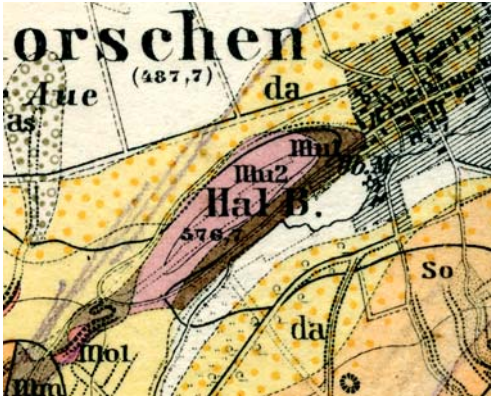
Abb. 3: Ausschnitt aus: Geologische Special-Karte von Preußen und den Thüringischen Staaten, Lieferung 45, Blatt Altmorschen; Berlin 1889. Signaturen: as = Schuttkegel (Alluvium), da = Schotter einheimischer Gesteine (Diluvium), mu1 = Unterer Wellenkalk, mu2 Oberer Wellenkalk mit Schaumkalk, mm = Mittlerer Muschelkalk, mo1 Trochitenkalk (Oberer Muschelkalk), So = oberer Buntsandstein.
