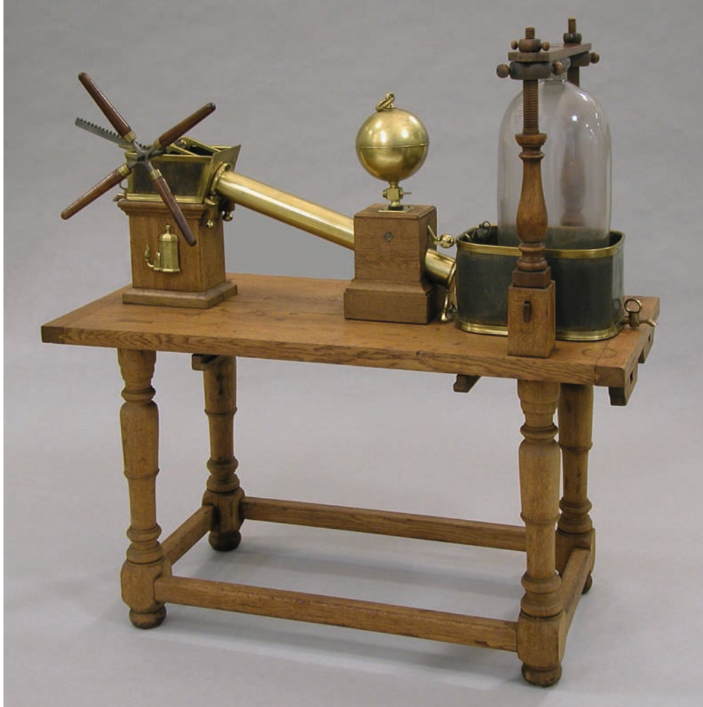
Abb. 8: Luftpumpe für Vakuumexperimente aus der Musschenbroek-Werkstatt in Leiden, 1686. Unterhalb des Drehkreuzes ist das in Messing getriebene Firmenzeichen der Musschenbroeks zu sehen, eine brennende Öllampe mit stilisierten gekreuzten Schlüsseln, dem Wappen der Stadt Leiden (Standort und Foto: Astronomisch-Physikalisches Kabinett, Kassel, Inventarnummer M 80).
