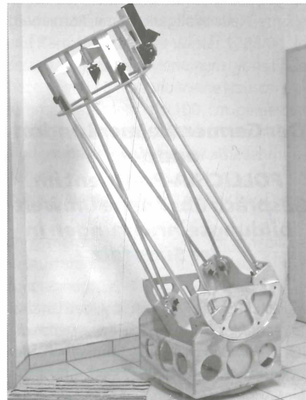
Abb. 2: Spiegelteleskop nach Newton, gebaut von Armin Meyer.
