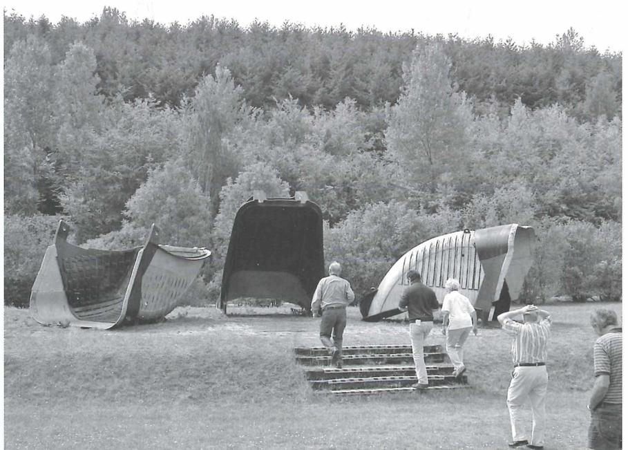
Abb. 2: Drei einzelne Schaufeln der Schaufelräder zum Tagebau-Abbau von Braunkohle. Dahinter gestufter Wald auf Rekultivierungsflächen. (Foto: H.-W. Helb)
