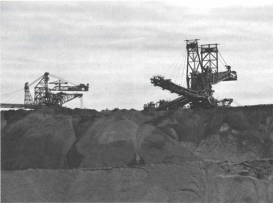
Abb. 7: Durch Absetzer wird der Tagebau mit Abraum aufgefüllt. (Foto: W. Nägle)
