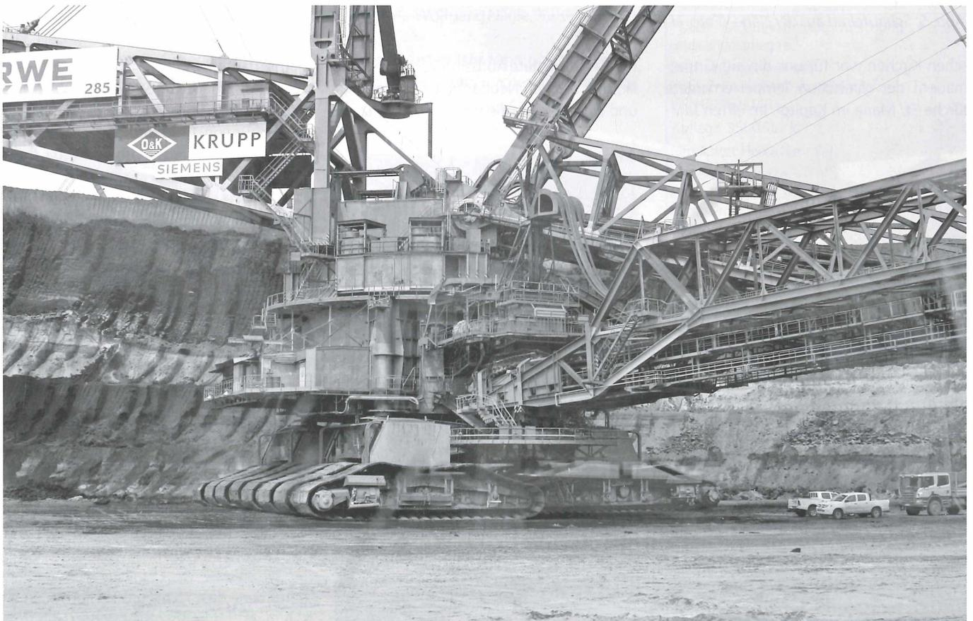
Abb. 4: Ein Schaufelradbagger-Riese von fast 100 m Höhe. Vergleiche die Autos rechts am Fuß und eine Person unten halblinks. Im Bedarfsfall überquert dieses Monster ganze Landschaften für einen Einsatzort-Wechsel. (Foto: H.-W. Helb)
