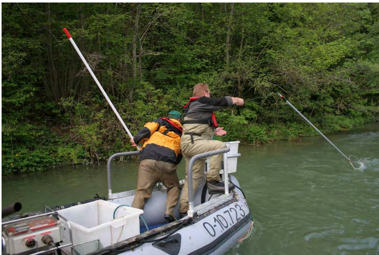
Abb. 84: E- Befischung bei überhängender Vegetation mit Handanode. Foto: Julia Lorber
