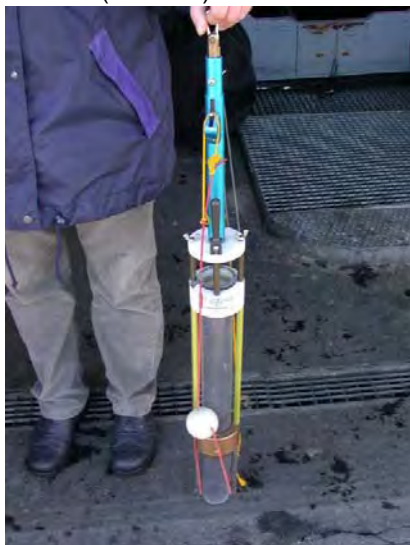
Abb. 66: Core zur Beprobung von Feinsubstraten des Profundales.
