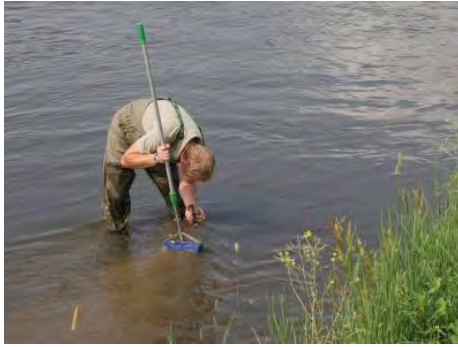
Abb. 65: MZB-Aufnahme mittels kick-sampling.
