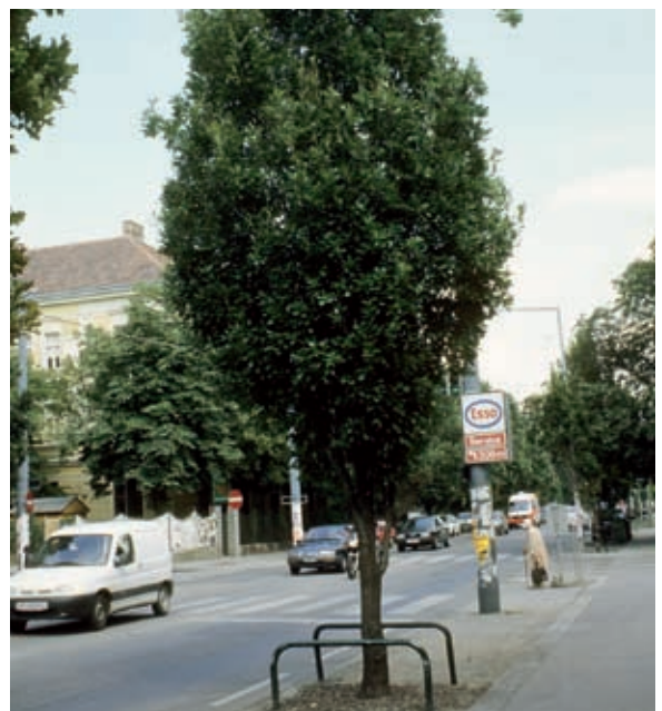
Baumschutzbügel verhindern Anfahrtschäden am Stamm und an den Wurzelanläufen.
