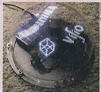
**1. Platz:** Das volumetrische 3-D-Display „visio“, das von der HTL3 Rennweg entwickelt wurde, ermöglicht die Darstellung von 3-D-Bildern, ohne dass eine Brille nötig ist. Die Bilder werden von auf verschiedenen Ebenen rotierenden Armen mit LEDs erzeugt. Eine neue Version mit höherer Auflösung ist in Arbeit.
