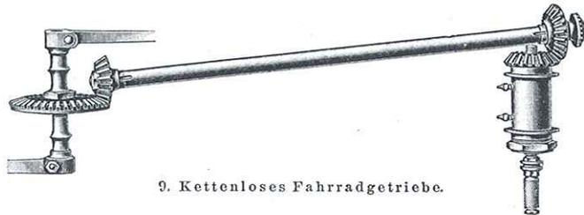
9. Kettenloses Fahrradgetriebe.
