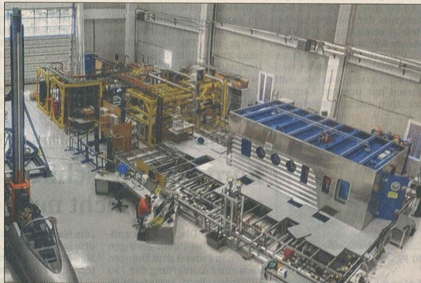
AMST-Montagehalle mit Schleudersitz- und Desorientierungs-Simulatoren. Foto: Werk
