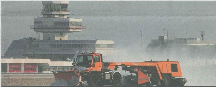
4 LKWs mit Kehrblasergerät und Schneepflug sind bei der Räumung im Einsatz.
