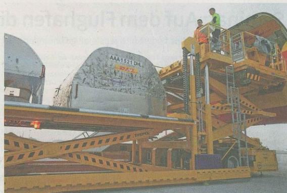
5.38 Uhr: Mit dem High-Loader werden die Container entladen.
