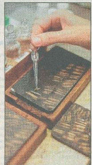
Drum prüfe, wer sich ewig bindet: Mit Königswasser wird die Echtheit untersucht.
