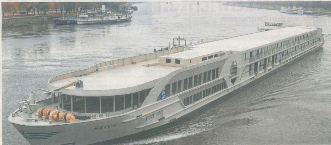
Erste Fahrt – noch – an Linz vorbei: Der Kasko (Rohbau) der „Savor“ auf dem Weg von Belgrad zur Fertigstellung in den Niederlanden.
