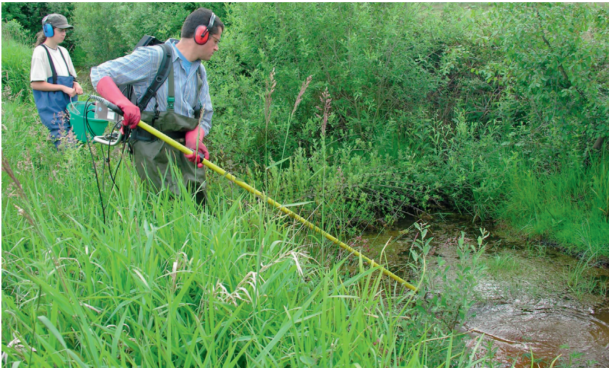
Abb. 2: Elektrobefischungen stellen die Standardmethode dar; hier: Watbefischung entlang eines Grabens (Foto: THOMAS BRANDT).
