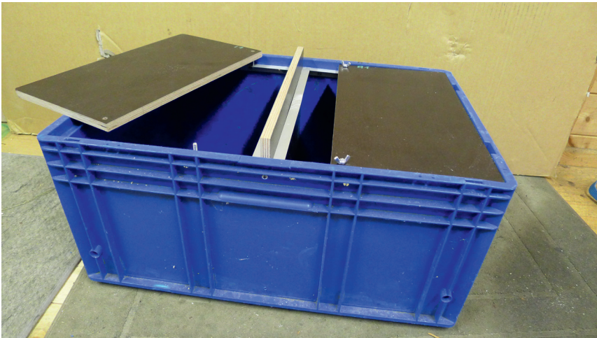
Abb. 5: Double-Catch-Box. Zu sehen sind unter anderem die abdeckenden Siebdruckplatten, die den Zugang für Prädatoren verhindern sollen, Aluminiumwinkel, welche das Herausklettern der Molche verhindern und die überstehende Siebdruckplatte, welche die Kiste in der Mitte teilt und an die die Leitwand angeschraubt wird (Foto: Bruno Scheel).
