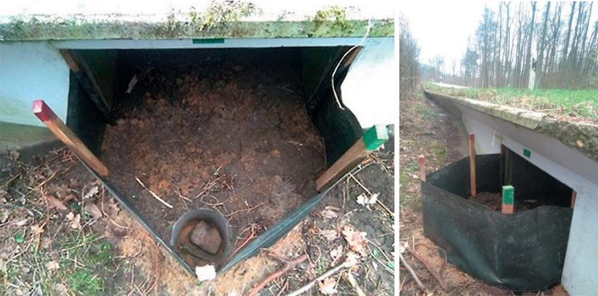
Abb. 2: Aufgebaute Fangvorrichtung vor einem Tunnelausgang (mit Holzpfosten aufgespannte, blickdichte Folie, im Boden eingegraben), links: Aufsicht; rechts: seitliche Ansicht (Fotos: Susanna Adler).
