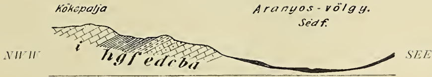
Profil VII. a—c graue Dolomitbänke; d brauner Dolomit; e tuffiger Dolomit; f grauer, klumpiger Mergel; g Fundort von eingekrusteten Fossilien; h hellgelblicher, plattiger Mergel; i Hauptdolomit
