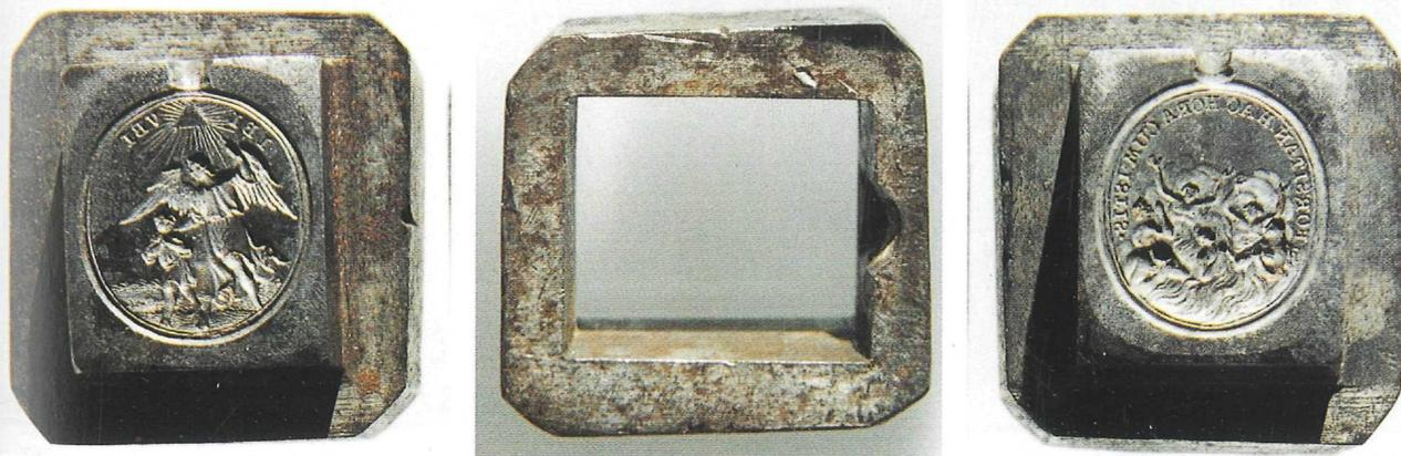
Abb. 8: Prägewerkzeug, bestehend aus drei Teilen: a) Vorderseite, b) Rückseite, c) Ring für die Fassung der beiden Stempel; 18. Jh.; Aufn. U. P. Schwarz, LMK
