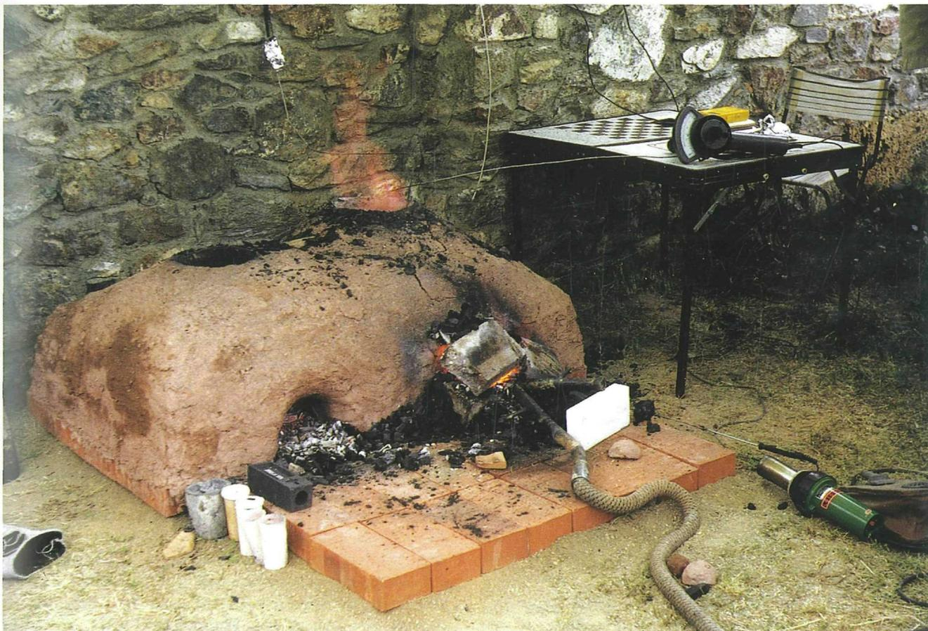
Abb. 1: Für Versuche wurde in einem von Dr. Dolenz veranlassten Ofen mit Schamotte-Tiegeln Bronze (SP ca 1040 C) geschmolzen; im Bild Tiegel und Graphit-Gussform, Temperatur-Messgerät HB-Pyropto am Tisch; Aufn. GS-N660/20/2001
