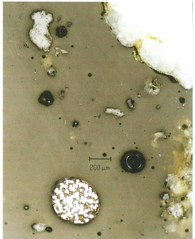
Abb. 4: Schlackenprobe MBG II vom Magdalensberg; Schlackenmatrix glasig, mit goldhaltigem kugeligen Einschluss neben Quarz-Körnern; Aufn. GS-N 663/14/2001
