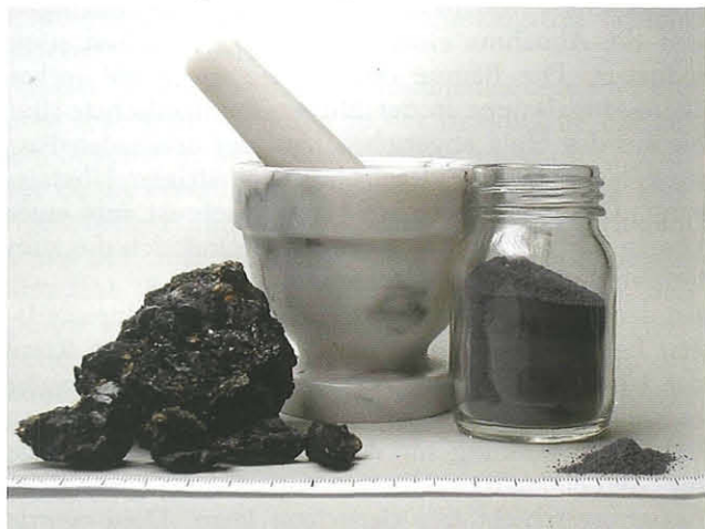
Abb. 19: Stinkspatbrocken aus Wölsendorf und seine Zerkleinerung bis zur pulverigen Form. Aufn. U. Bültmeyer
