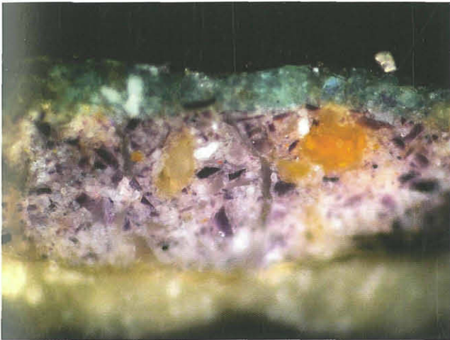
Abb. 14: Mikroskopische Aufnahme eines Querschnitts durch die blaue Malschicht am Relief K 202, LMK. Aufn. U. Bültmeyer
