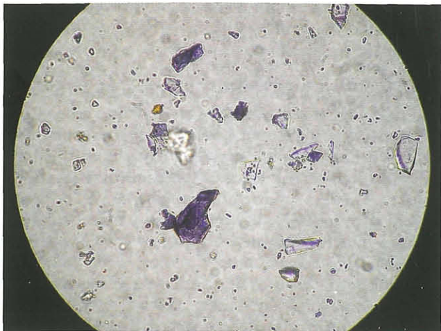
Abb. 18: Mikroskopische Aufnahme der Fluoritpartikel am Relief K 202, LMK, im Polarisationsmikroskop. Aufn. U. Bültmeyer
