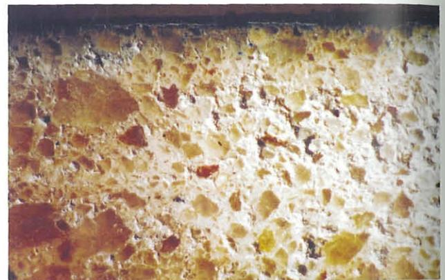
Abb. 19: Putzschichten aus Marmor – NORICUM – Bildbreite 13 mm. Aufn. L. Heck
