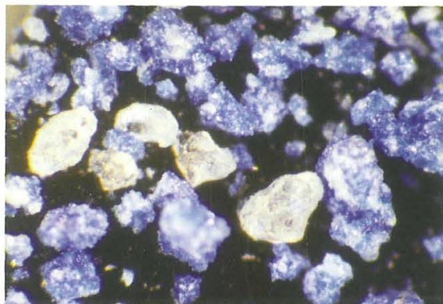
Abb. 5: Ägyptisch Blau – Kugelabrieb auf Träger; Probe NORICUM 1.1; Bildbreite 2 mm. Aufn. L. Heck
