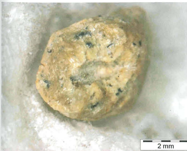
Abb. 6 und 7: Winzige schwarze Partikel im Material konnten als Reste von Holzkohle identifiziert werden. Aufn. F. Walter
