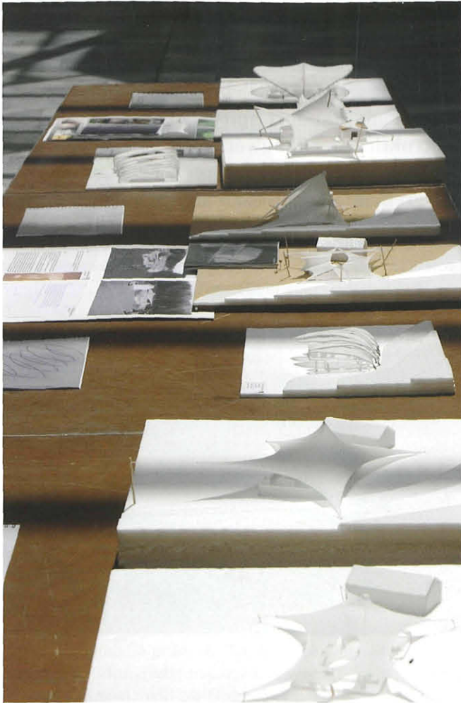
Abb. 3: Tragwerksentwürfe aus Strumpfgewebe
