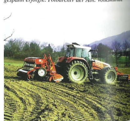
Abb. 15: Das Eggen, Säen und Walzen mit modernen Kombinationsgeräten und einem leistungsstarken Traktor wird heute in einem Arbeitsgang von einer einzigen Person ausgeführt. Aufn. Landwirtschaftskammer Kärnten
