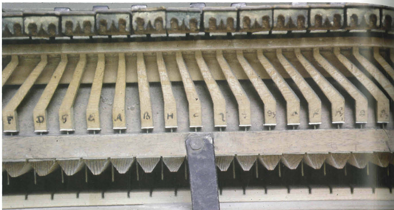
Abb. 9: Tastenvorderfront, Stechermechanik bei offener Windlade. Aufn. I. Mattitsch
