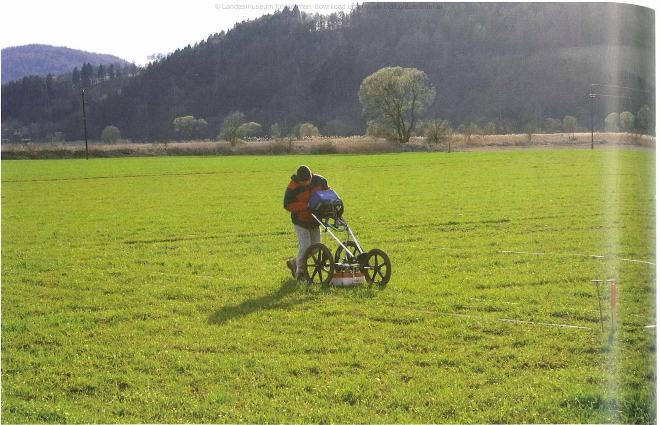
Abb. 4: Messungen mittels Georadar am Zollfeld. Aufn. R. Barlovits
